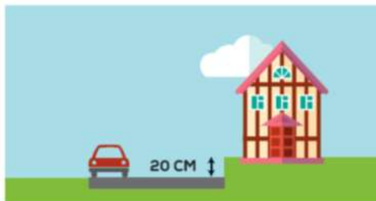
Figure 8 : Principe du seuil au moins de 20cm au-dessus du niveau de voirie principale
