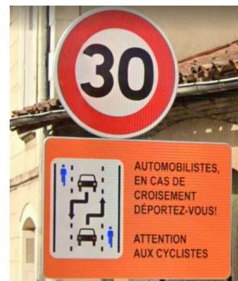
Un **chaussidou** est une chaussée à voie centrale banalisée. ... Soit un partage de la chaussée en trois espaces : Une voie centrale sans marquage au centre pour les voitures, camions et motos. Deux voies latérales pour la circulation des deux-roues.
